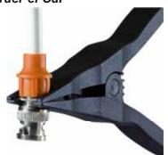
Posicionar la ranura especial del conector en la parte especifica (forma tenedor) de la PiCaP, y presionar las extremidades de la pinza para abrir la conexión.
