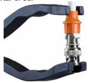
Insertar el conector entre las extremidades de la pinza, procurando posicionar cada conector en la parte correcta, y presionar las extremidades de la pinza para terminar la conexión.
